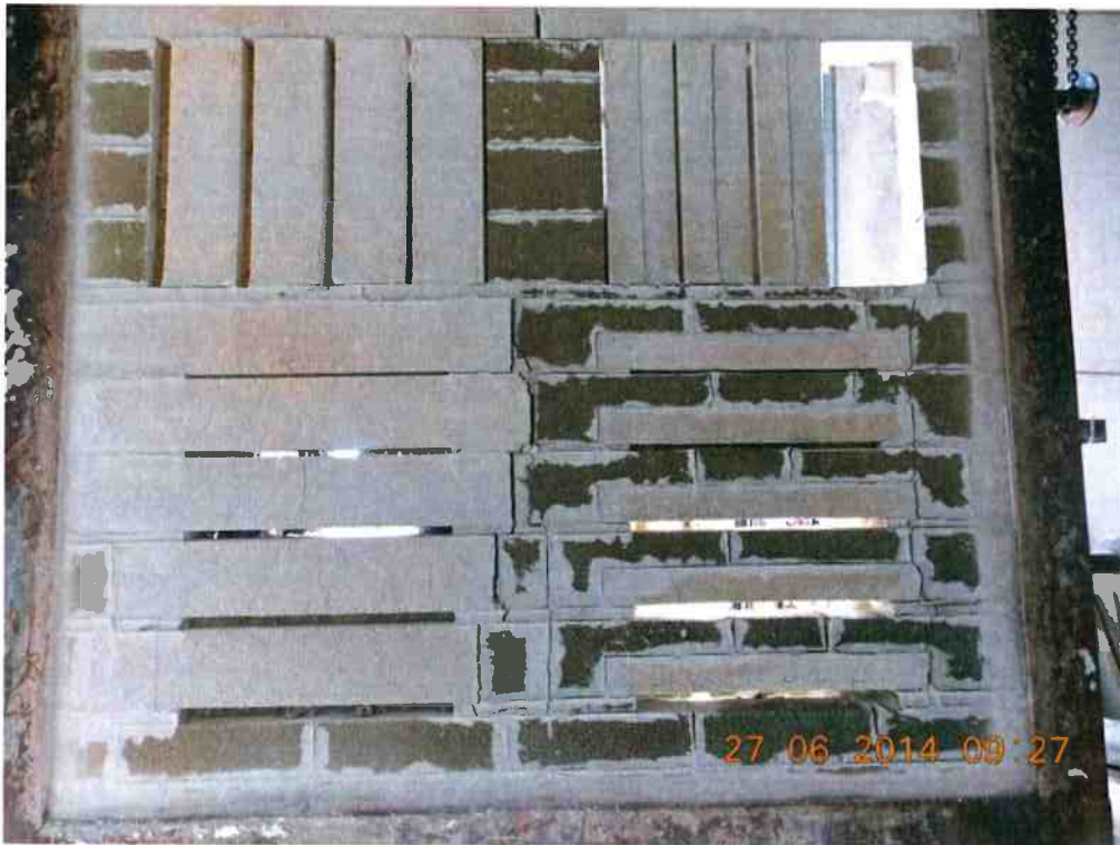
Foto 4. Lato esposto al fuoco dei campioni dopo la prova
