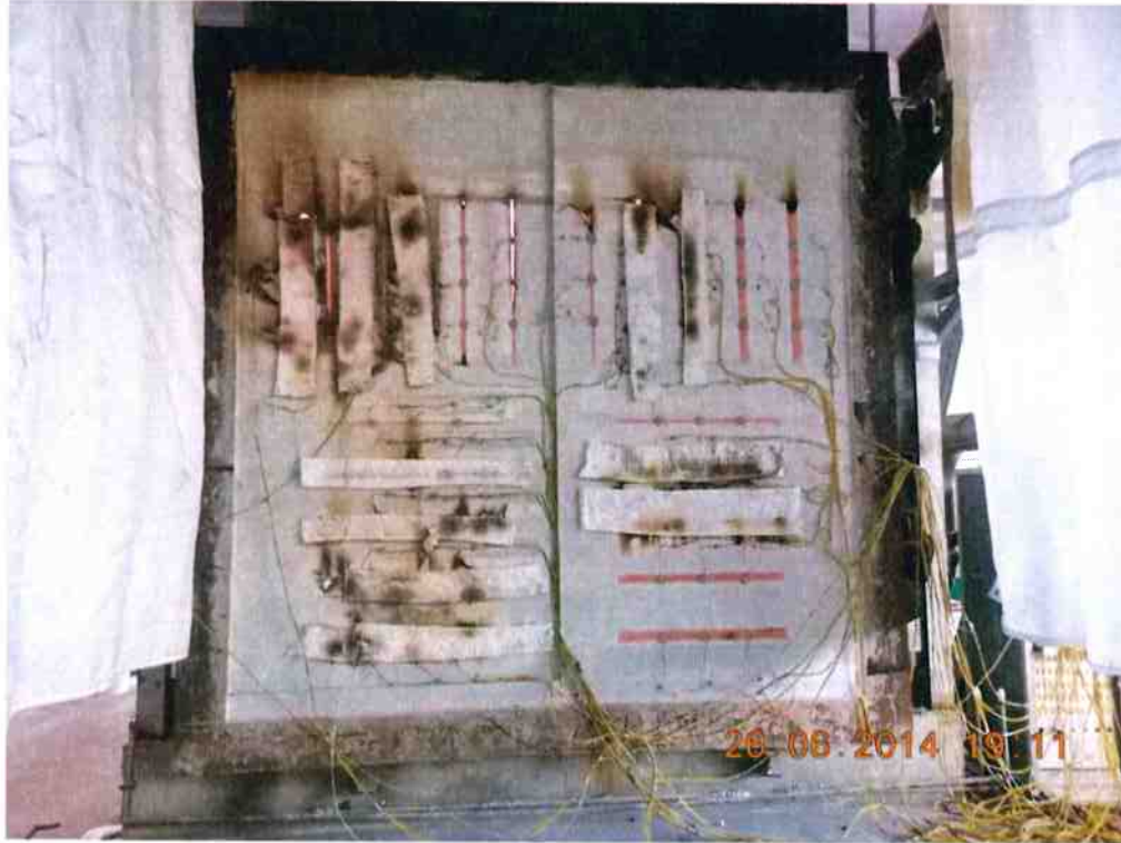
Foto 3. Lato non esposto al fuoco dei campioni dopo la prova
